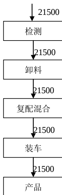
图 2.5-4 液态外加剂分装物料平衡图 单位：t/a
