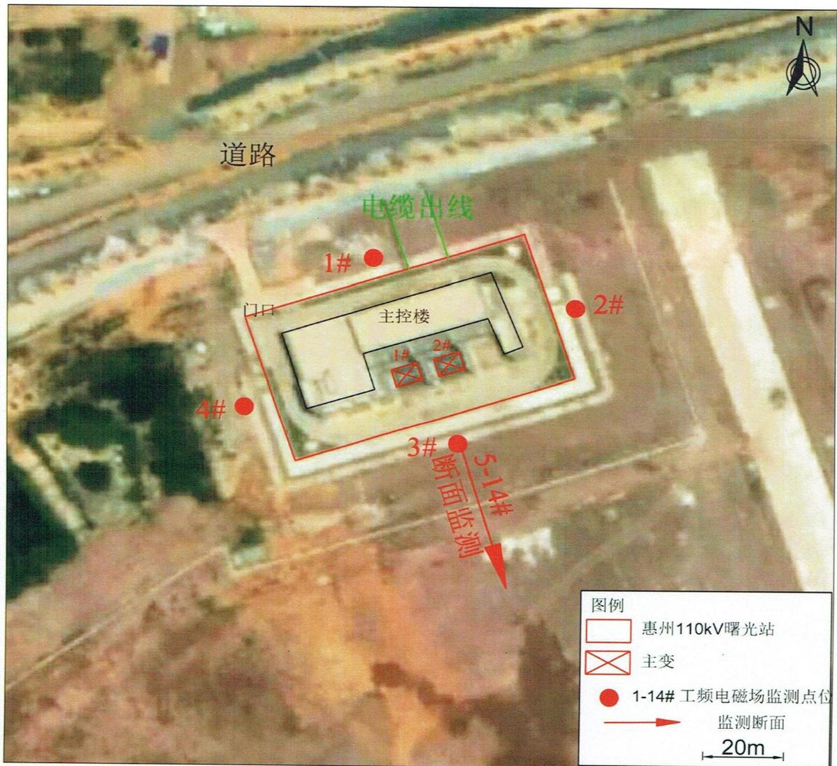
图 3 惠州 110 千伏曙光变电站监测布点图
