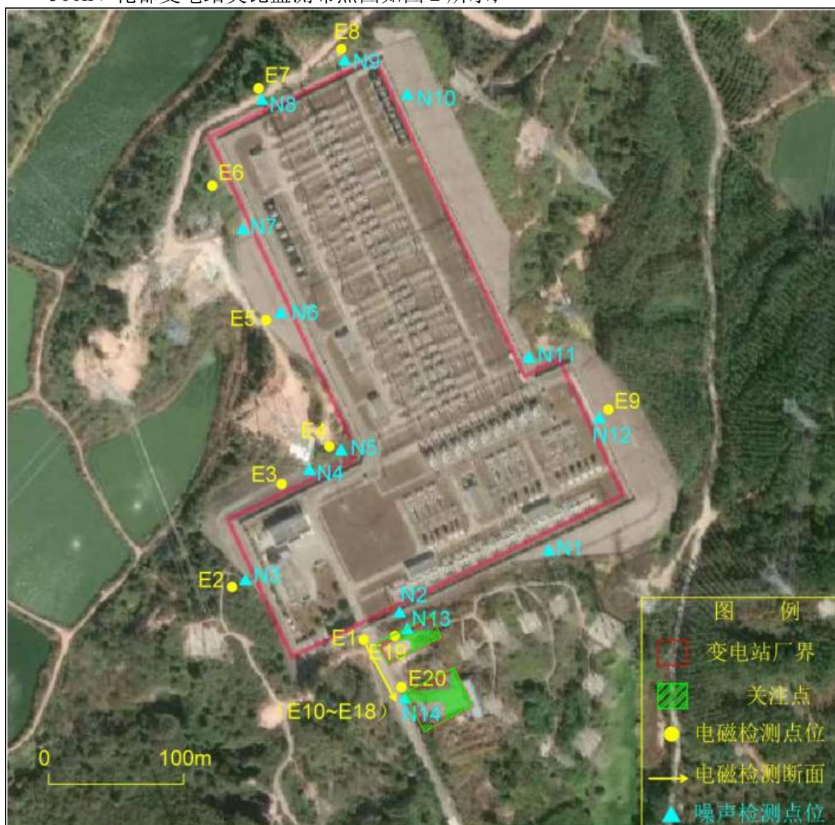
图 2 500kV 花都变电站监测布点图
