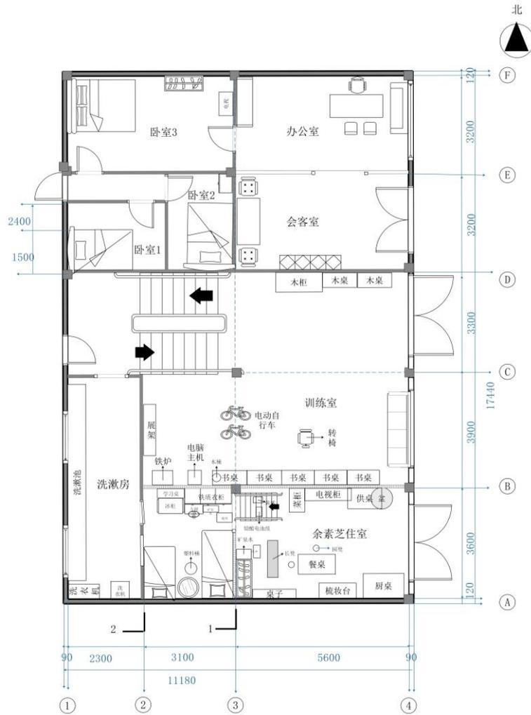
图3-1 临街门面房一层平面图
